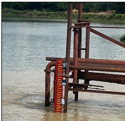
รูปที่ 33 เครื่องมือวัดปริมาณน้ำที่สูบจากบ่อสำรองน้ำดิบ
