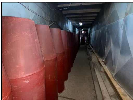
รูปที่ 6 อะไหล่และอุปกรณ์ซ่อมบำรุงระบบดักฝุ่นละอองจากหม้อไอน้ำ
