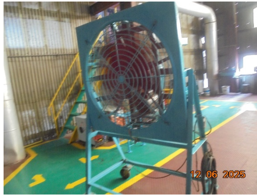
รูปที่ 66 ติดตั้งพัดลมถ่ายเทอากาศ ระบายความร้อนในพื้นที่ปฏิบัติงาน
