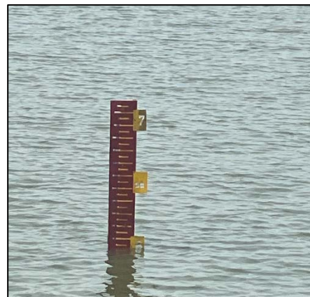
รูปที่ 33 เครื่องมือวัดปริมาณน้ำที่สูบจากบ่อสำรองน้ำดิบ
